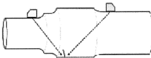
Slika 1. Površinska ispitivanja poprečnih naprsline.
