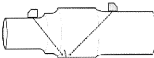
Slika 1. Površinska ispitivanja poprečnih naprslina.
