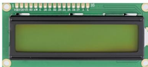
Slika 8. HD44780 LCD displej. Figure 8. HD44780 LCD display.
