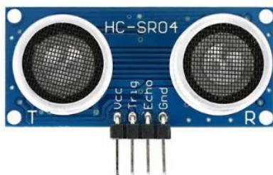
Slika 7. Ultrazvučni senzor rastojanja. Figure 7. Ultrasonic distance sensor.
