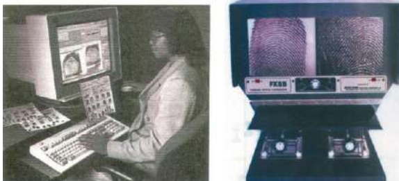
Slika 10. Računarski sistem SAFIS MORPHO za unošenje/memorisanje nespornih otisa prsta i uređaj za komparaciju nespornih i spornih otisaka prsta.
